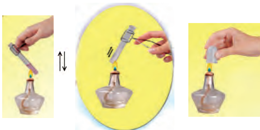
Мал. 21. Так треба нагрівати речовину в пробірці
