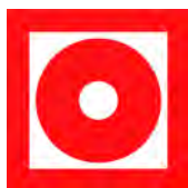
Кнопка включення систем пожежної автоматики
