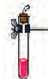
Мал. 15. Так треба закріплювати пробірку в штативі
