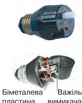
Рис. 4.3. Принцип дії автоматичного побутового запобіжника ґрунтуються на тепловому розширенні біметалової пластинки
