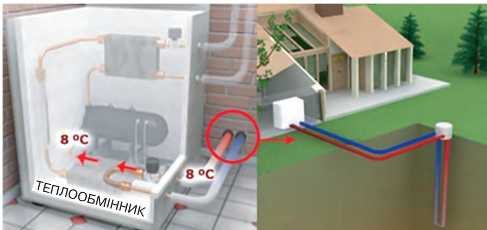
Рис. 17.6. Принцип дії ґрунтового геотермального теплового насосу
