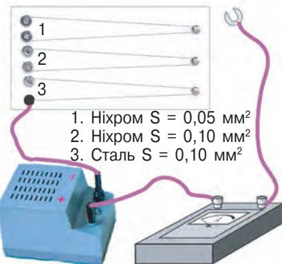
Рис. 28.1. Дослід для визначення залежності опору металевого провідника від його довжини, площині поперечного перерізу та роду речовини
