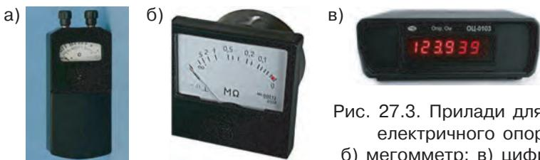
Рис. 27.3. Прилади для вимірювання електричного опору: а) омметр; б) мегомметр; в) цифровий омметр
