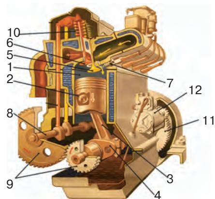
Рис. 16.2. Будова поршневого двигуна внутрішнього згоряння
