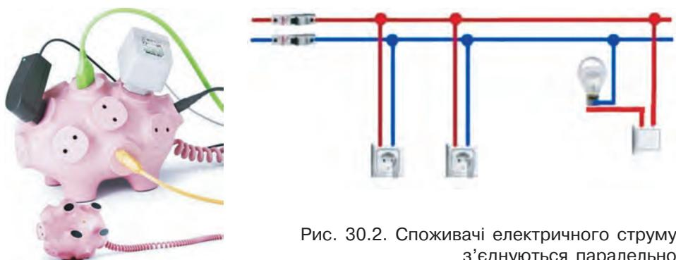
Рис. 30.2. Споживачі електричного струму з'єднуються паралельно
