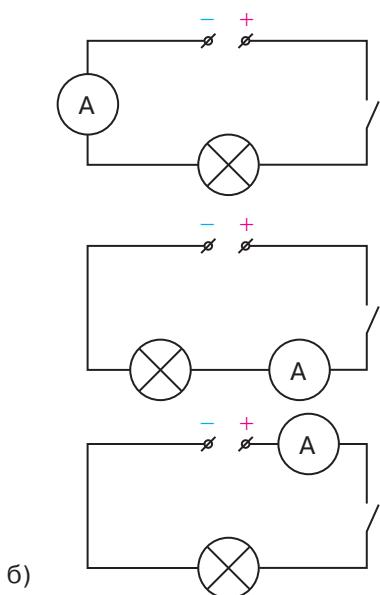
Рис. 25.3. Вимірювання сили струму амперметром:
