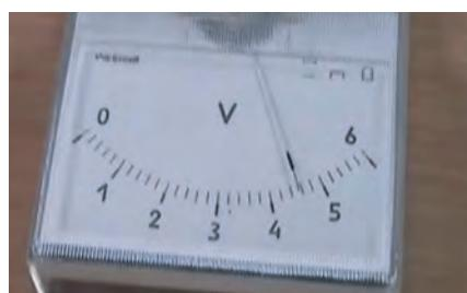
Рис. 26.3. Шкала вольтметра
