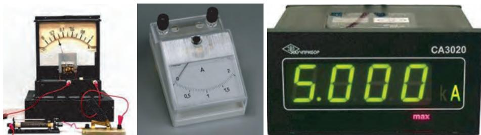
Рис. 25.2. Амперметри: а) демонстраційний; б) лабораторний; в) цифровий
