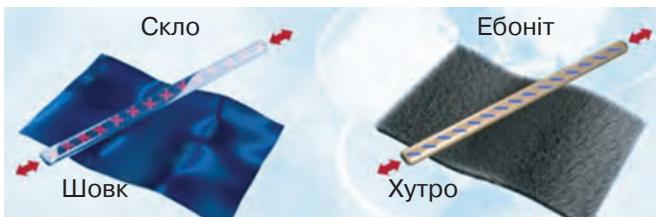
Рис. 18.5. Позитивний заряд утворюється на склі, потертому об шовк, негативний — на еbonіті, потертому об хутро
