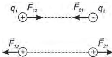
Рис. 19.2. Напрям сили Кулона під час взаємодії одно- та різноменних зарядів
