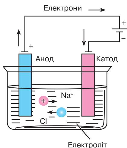
Рис. 34.3. Йонна провідність розчину кам'яної солі  $\text{NaCl}$
