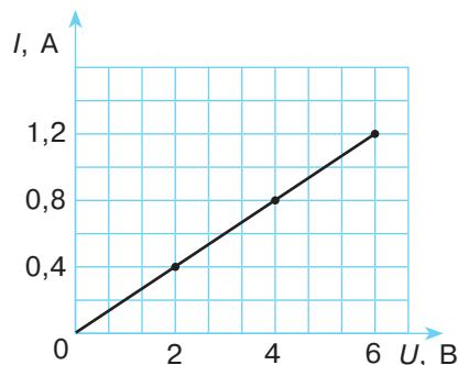
Рис. 27.5. Залежність сили струму в провіднику від напруги на його кінцях
