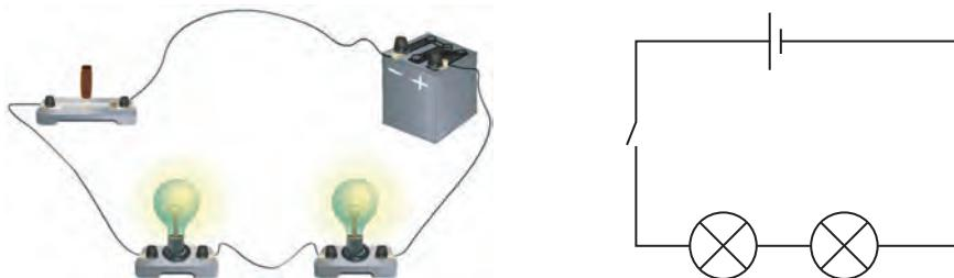
Рис. 29.1. Послідовне з'єднання елементів електричного кола
