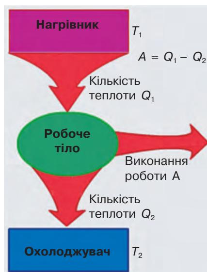
Рис. 15.3. Загальна схема теплої машини С. Карно
