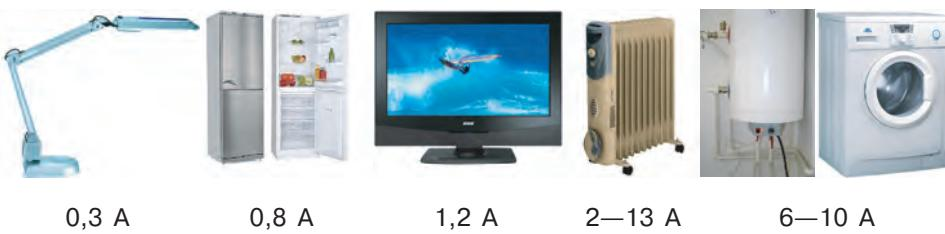
Рис. 36.2. Сила струму електропобутових пристрой
