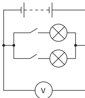
Рис. 30.3. При паралельному з'єднанні провідників напруга на всіх ділянках електричного кола одна ідентична
