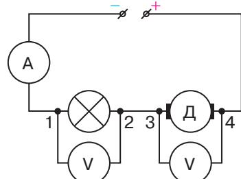
Рис. 26.2. Вимірювання електричної напруги вольтметром:
