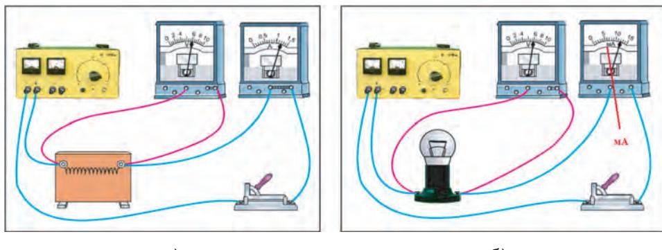
Рис. 27.1. При однаковій напрузі на кінцях різних провідників сила струму в них може відрізнятися:
