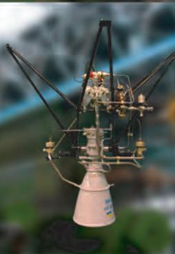
Рис. 16.5. Реактивний двигун РД-108 конструкції В. П. Глушко для ракети-носія Р-7 С. П. Корольова
