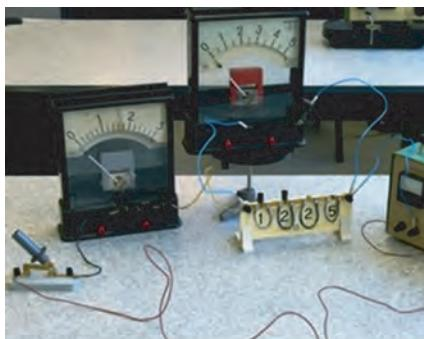
Рис. 27.6. Дослідження електричного кола з провідниками різних опорів
