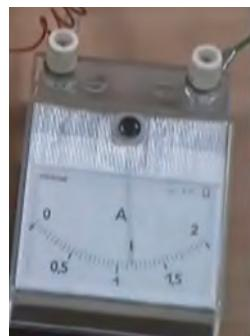
Рис. 25.4. Шкала амперметра
