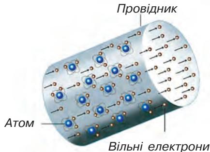
Рис. 23.1. Між іонами кристалічних ґраток металу рухаються вільні електрони
