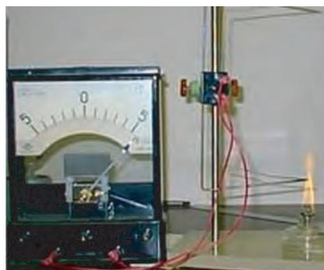
Рис. 24.4. Внутрішня енергія нагрівника перетворюється в електричну
